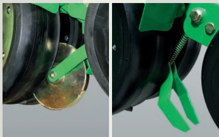
Gumi, vagy INOX magnyomó pro- kerék, csapógyazott lengőkarra szerelve. A kerekek könnyen leszerelhetők.
